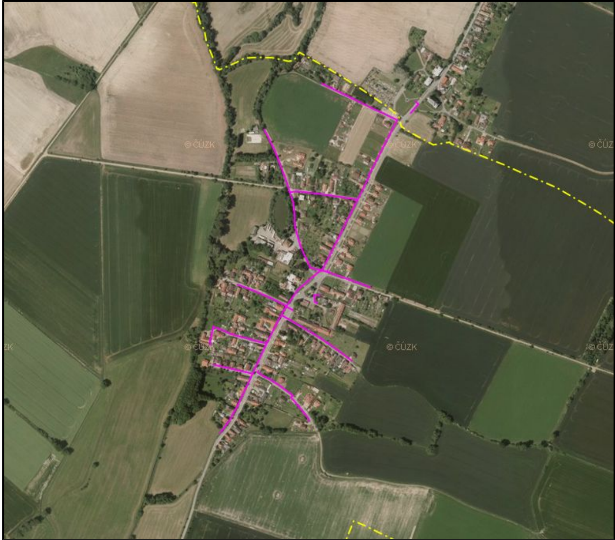
Obr. č. 8: Systém veřejného osvětlení v obci Mokrovousy
